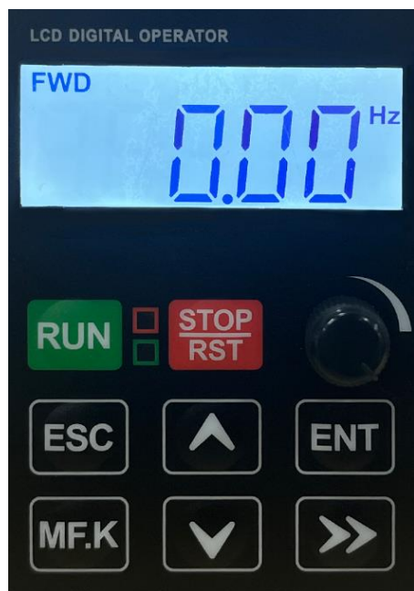
Рис. 4-1. Панель управления. Расположение кнопок управления и индикация
