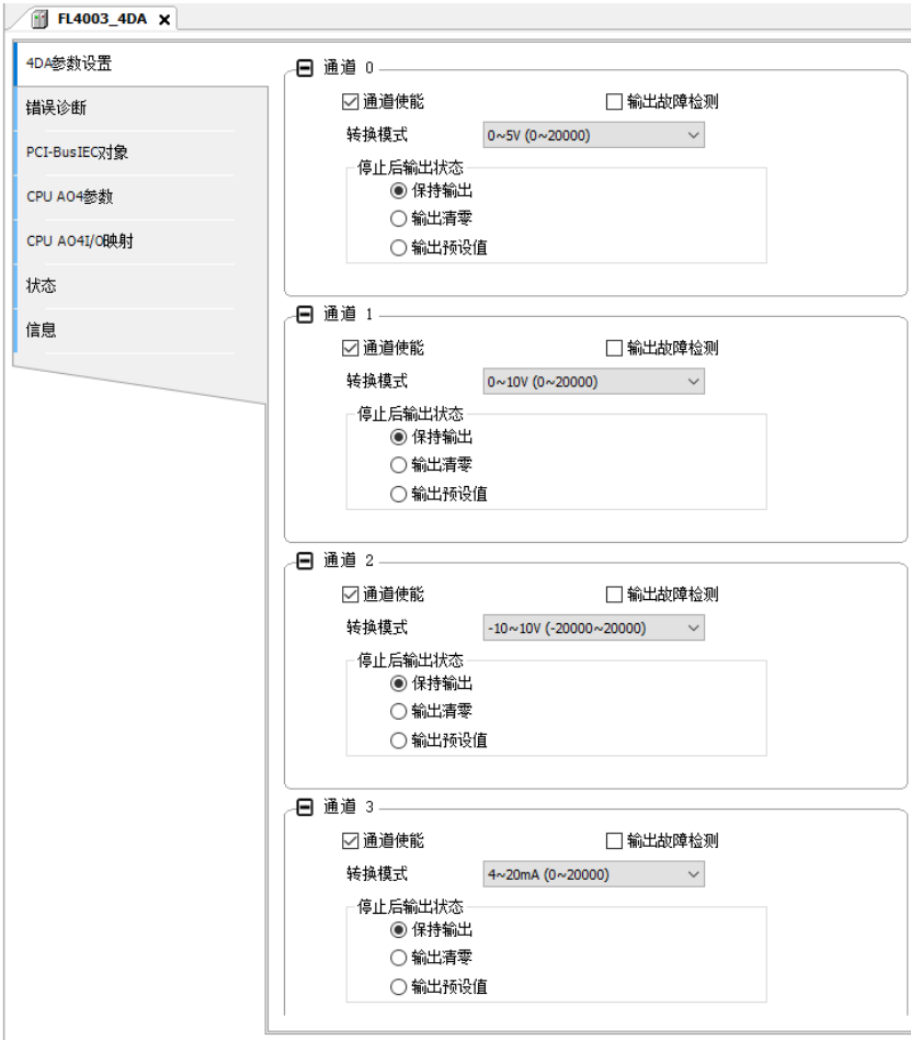
图 4-23 模拟量输出变量映射
