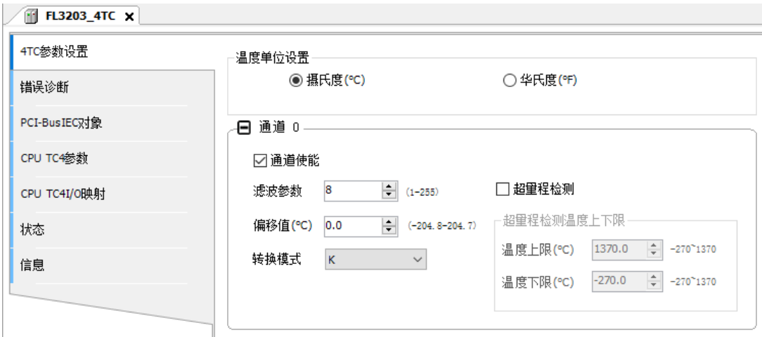
图 4-26 温度模块 4TC 配置
