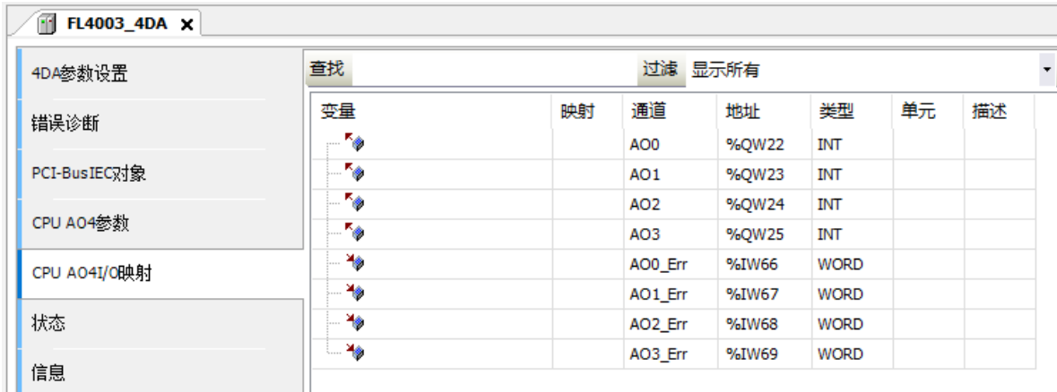
图 4-24 模拟量输出模块变量映射
