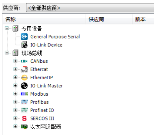
图 12.1 CoDeSys 支持的现场总线通信协议
