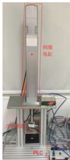
9.28 PID 控制力矩输出试验台
