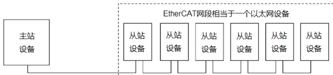
图 12.96 直连模式中的 EtherCAT 网段
