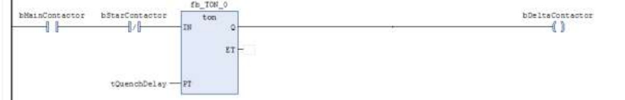
图 10.X 三角形接触器吸合程序段
