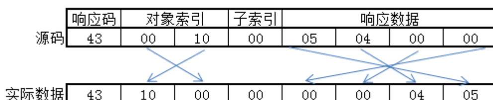
图 12.12 CAN 报文源码对应实际数据
