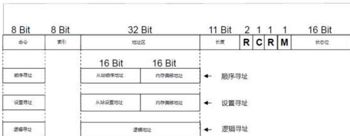
图 12.100 EtherCAT 的设备寻址结构
